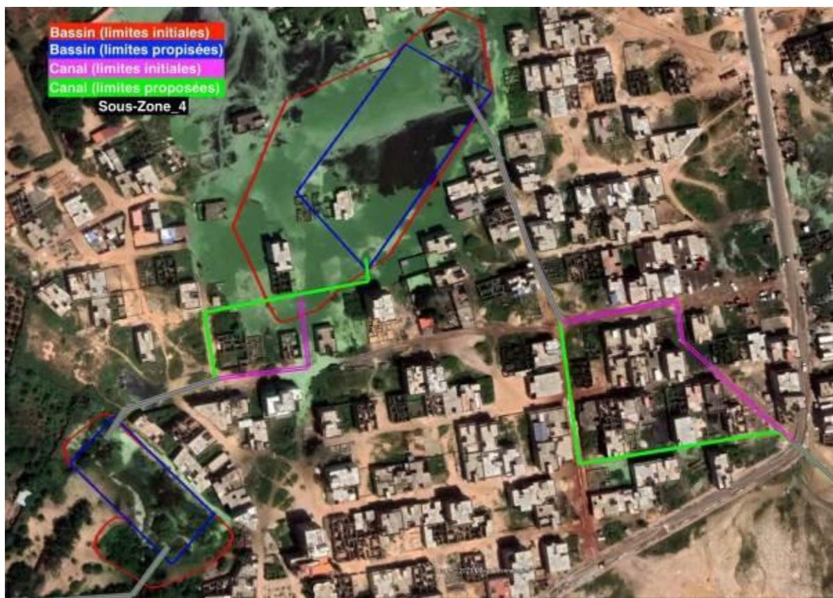
Photo 2 : Exemple d'optimisation des bassins et des tracés des canaux pour minimiser la réinstallation
